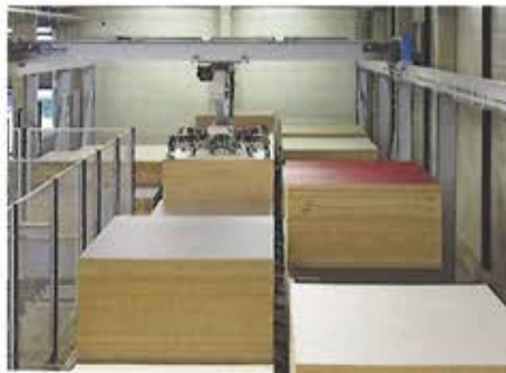
/ Das Plattenlager TLF 411 versorgt die beiden Sägen vollautomatisch und in definierter Reihenfolge.
