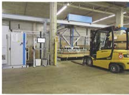
/ Das angelieferte und mit dem Stapler bereitgestellte Plattenmaterial wird automatisch eingelagert.
