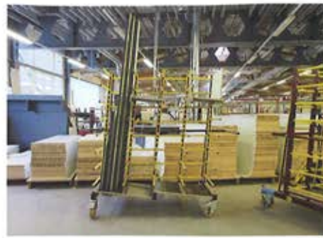
/ Für die Weiterbearbeitung nach dem Zuschnitt werden die Teile in Kommissionierwagen abgestellt.
